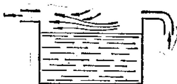
图 6-5 吹吸式槽边排风罩作用示意图
