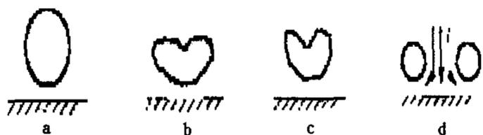
图 1 气泡在刚性固体表面破裂的示意图
